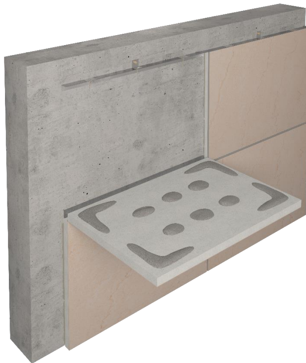
Рис. 6. Нанесение цементно – полимерного клеящего раствора
