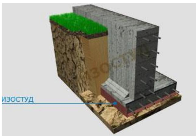
Использование мембранны ИЗОСТУД является наилучшим решением при замещении традиционной бетонной подготовки, так как, наряду с прекрасными техническими характеристиками ИЗОСТУДА, укладка этой мембранны дает большие экономические преимущества. После того как котлован вырыт на 1 — 2 сантиметра ниже отметки фундамента, грунт снивелирован и утрамбован, укладывается ИЗОСТУД. Учитывая то, что погодные условия не влияют на проведение работ, процесс укладки происходит быстро.
