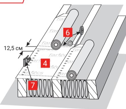
Зафиксируйте мембрану на кровле степлером или гвоздями с широкой шляпкой. Линии перехлеста необходимо соединить двухсторонней монтажной лентой farAcs.
