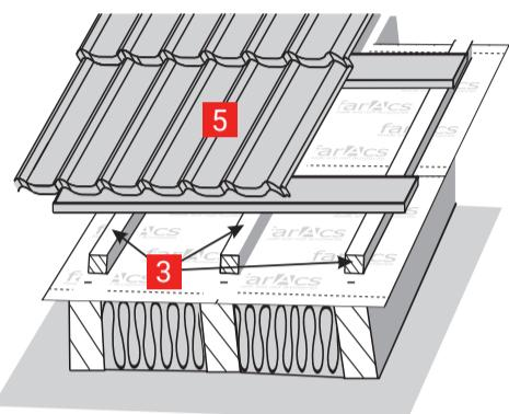
Диффузионная мембрана FARACS используется в конструкциях кровли с вентиляционным зазором. Укладка производится непосредственно на утеплитель без провисания полотна. Нанесенная на мембрану разметка должна располагаться с внешней стороны.
