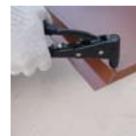
Клещи заклепоч- ные. Предназначены для соединения изделий с помощью вытяж- ных заклепок.
