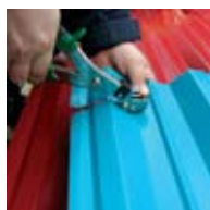
Ножницы просеч- ные по металлу и комплект сменных ножей. Для ручной резки стали толщиной до 0.6 мм.
