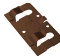
Крепежный кляммер завершающий с дистанциром ККСД-37x10, t=1.2 мм
