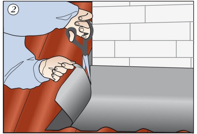
2 Надрезать верхнюю часть ленты в нижнем углу трубы
