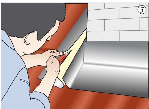
Боковую полосу вдавить в угол к боковой стороне трубы и подрезать верхнюю кромку
