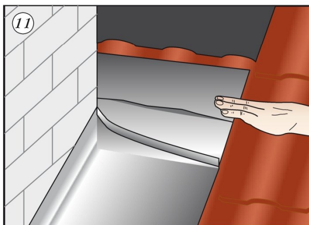
11 К верхней полосе приклеить еще одну свинцовую полосу
