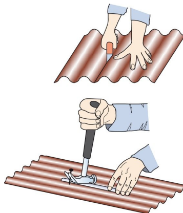
Рис. 18. Разрезка листа и вытаскивание неудачно вбитого гвоздя
