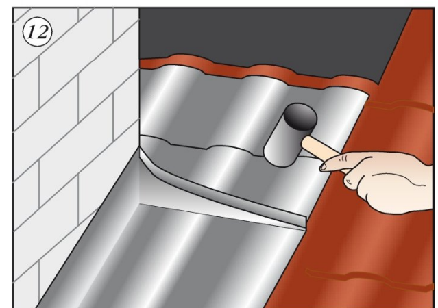
12 Простучать молотком все полосы, придав им профиль кровли
