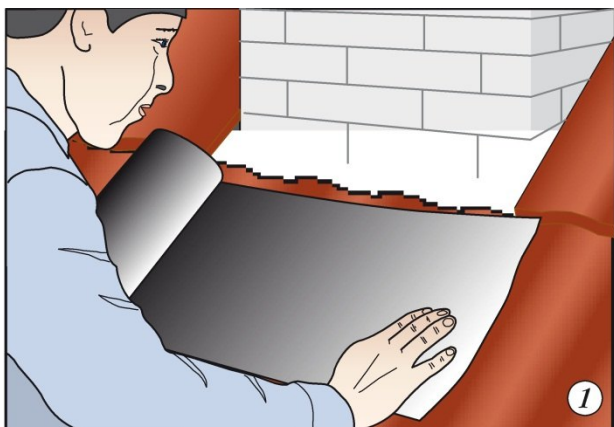
Отмерить и отрезать свинцовую полосу
